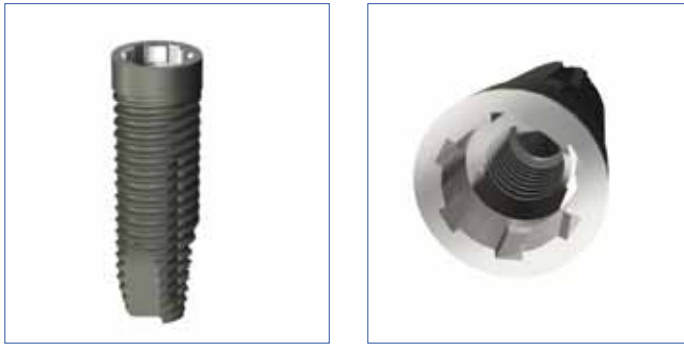
Abb. 47 und 48 Die spezielle Geometrie des Neoss-Implantats formt das Implantatbett in weichem Knochen. Die Innenverbindung sorgt für eine Rotationssicherung durch Deformationszonen, vermeidet Schraubenlockerungen bei Dauerbelastung und erleichtert die Abformung
