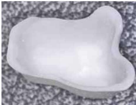
Abb. 32 Die Zirkonkappchen werden bis auf 0,3 mm ausgedünnt
